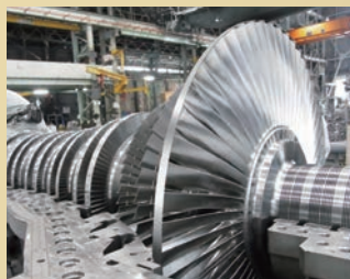
蒸気タービン
