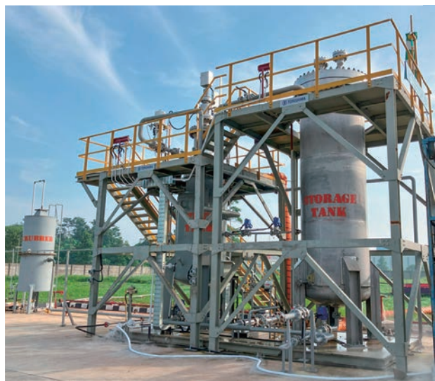
インドネシア子会社でのアンモニア実液を用いたポンプ運転試験
