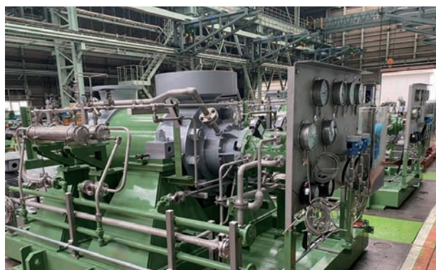
アメリカ南部に2025年に納入されたBFP(工場出荷時撮影) (ポンプ形式:MHG、原動機容量:9MW)
