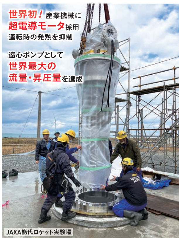
JAXA能代ロケット実験場 -253℃の液化水素を用いた運転試験(2024年3月)
