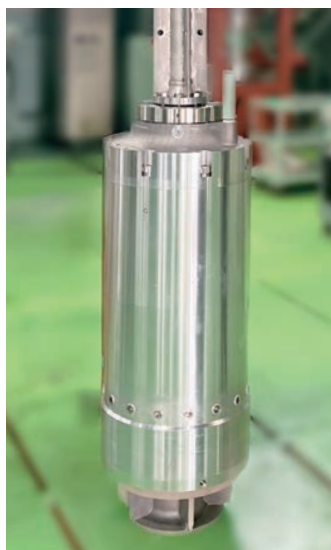
LNG Pump Exterior
