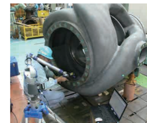
ポンプケーシングの 3次元スキャン
