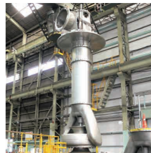
MSF法 海水淡水化プラント用 ライン再循環ポンプ
