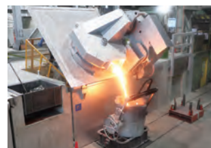
電気炉による金属の熔解、出湯
