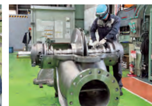
中形ポンプの組立
