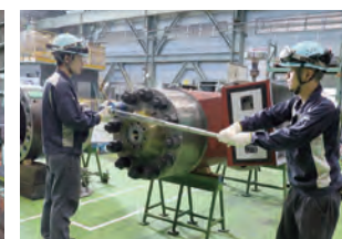
特殊ポンプの組立
