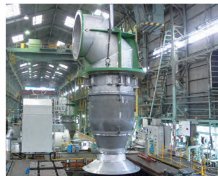
冷却水ポンプ(火力発電プラント)
