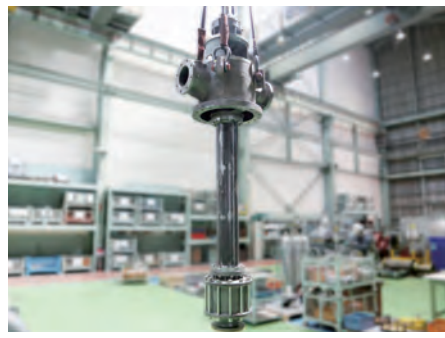
発電プラント向けアンモニア払い出しポンプ
