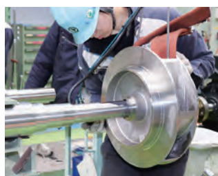
ポンプの回転体の組立作業
