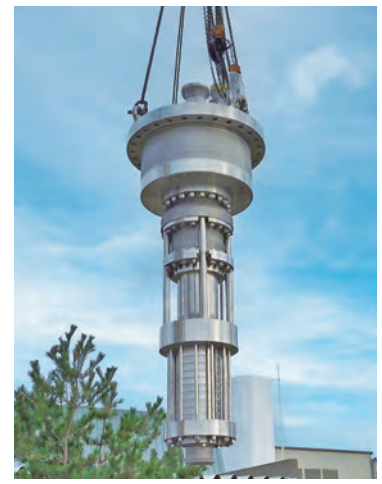
JAXAでの液化水素ポンプ運転試験
