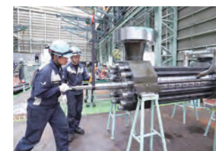
輪切型高压ポンプの組立
