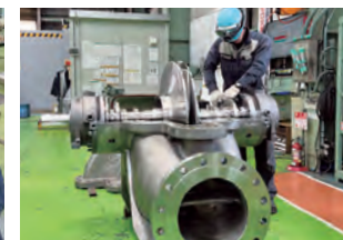
中形ポンプの組立
