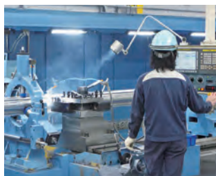
シャフトの旋削作業
