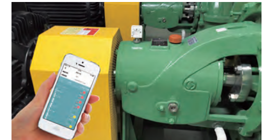
TR-COM(回転機械のモニタリングシステム)
