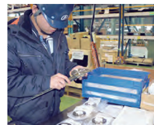
ポンプ部品の受入検査
