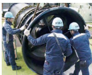
大形ポンプの組立作業
