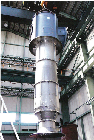
口径φ1400 排煙脱硫 装置用海水供給ポンプ (スーパー二相ステンレ ス鋼板製)
