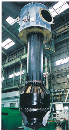
口径φ1000 海水淡水化 プラントのライン再循環 ポンプ (ステンレス鋼板+ 塗装)
