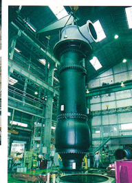
ブライン再循環ポンプ ラスファーンMSF海水淡水化プラント (カタール) 向 □ 径：1,200mm 原動機：3,800kW
