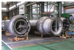
海水淡水化プラント用（造水機：30MIGD） 二相ステンレス製主海水ポンプ
