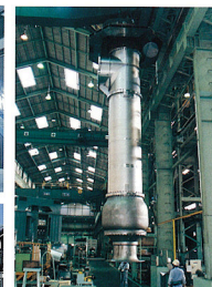
冷却水ポンプ P.A.I.シュアイバ (クウェート) 向 □ 径：1,400mm 原動機：4,100kW
