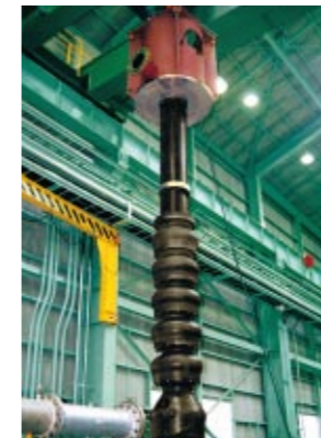
[高圧立軸多段タービンポンプ]
