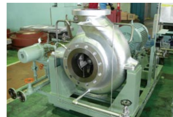
[熱水循環ポンプ]
