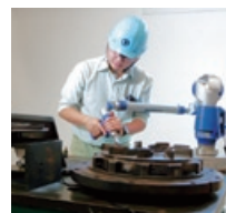
ポンプ(羽根車)の 3次元スキャニング
