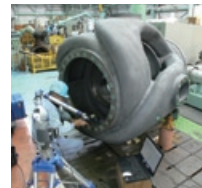
ポンプケーシングの 3次元スキャン
