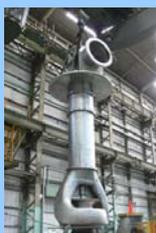
MSF法海水淡水化プラント用フライング再循環ポンプ
