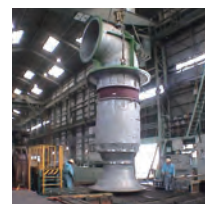
Насос циркулирующий воды с фабрикованным конструкцией
