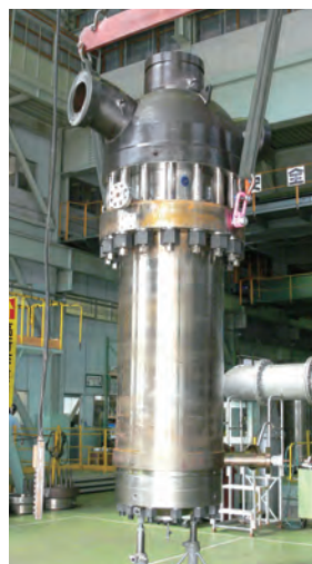
Циркуляционный насос котла
