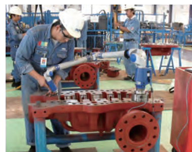
Сканирование деталей насосов для обновления в REDU
