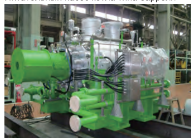
Питательный насос котла типа барреля
