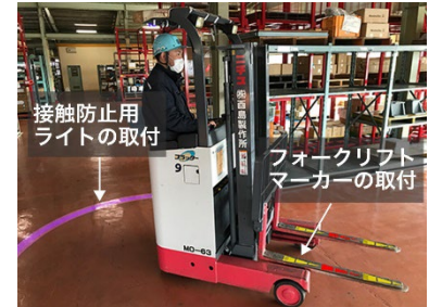
フォークリフトの安全対策例
