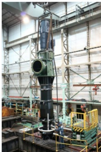
図1 「風冷式耐水モーター一体型ポンプ」の外観 モーター部分が水没しても運転を継続する。2022年3月に初号機を納入した。（写真：西島製作所） [画像のクリックで拡大表示]
