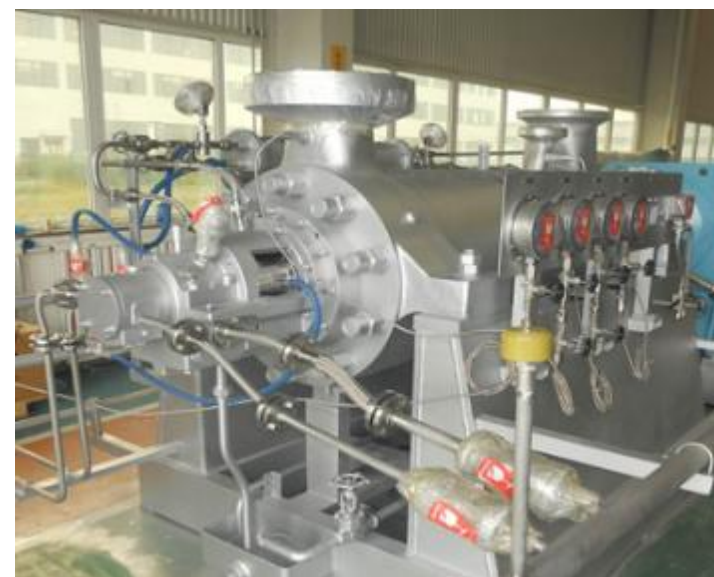
天津工場製造のボイラ給水ポンプ（マレーシア向け）
