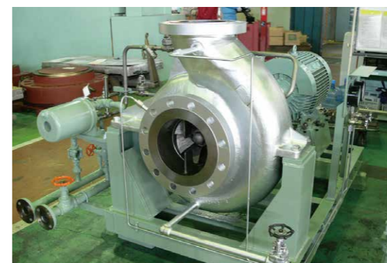
[熱水循環ポンプ]
