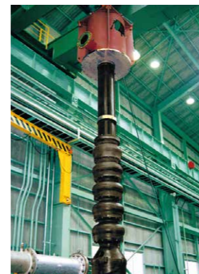
[高圧立軸多段タービンポンプ]
