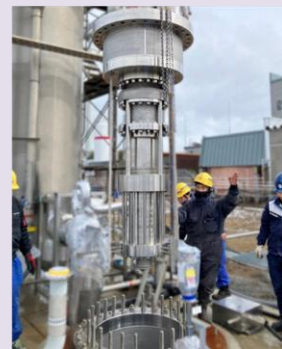
JAXAでの液化水素ポンプ運転試験
