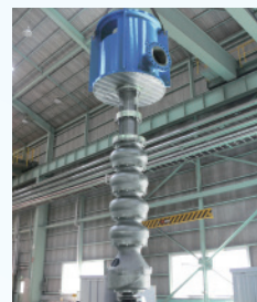
発電プラント用 アンモニア払出ポンプ
