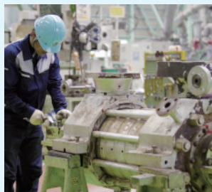
ポンプの工場持込整備
