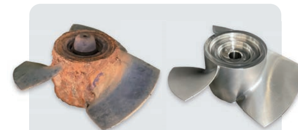
腐食した兵庫県下の河川排水ポンプ用インペラを、AM技術で新たに製作しました。
