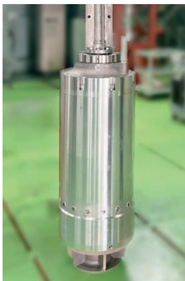
LNGポンプ外観
