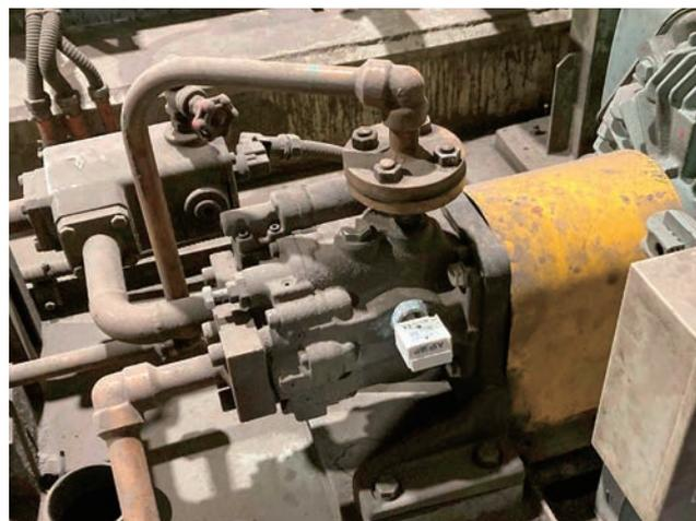
油圧ポンプに取り付けたセンサ (b-Monitor)
