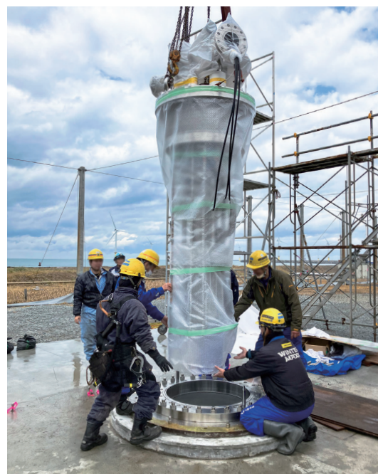
能代ロケット実験場での-253℃の液化水素を用いた運転試験
