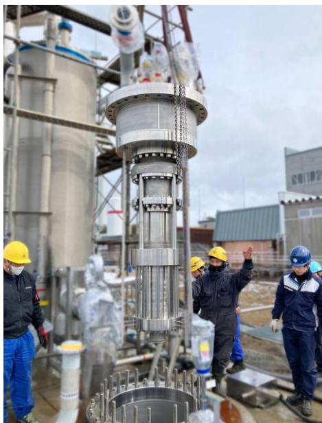
JAXAでの液化水素ポンプ運転試験（2024年）
