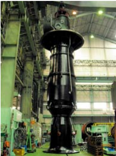
下水用 雨水排水ポンプ (先行待機型) 口径：1,650mm 原動機出力：2,690kW
