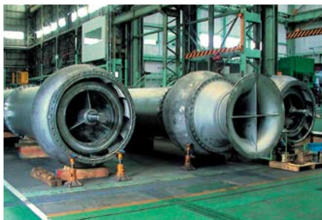
海水淡水化プラント向け(造水量:30MIGD) 二相ステンレス製海水ポンプ
