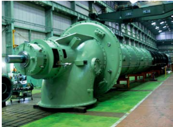
下水用 雨水ポンプ (先行待機型) 口径：2,000mm 原動機出力：3,100kW
