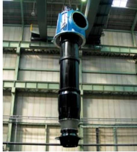
下水用 雨水排水ポンプ (鋼板製) 口径：1,100mm 原動機出力：470kW
