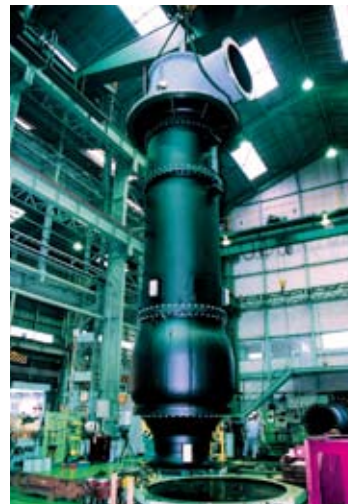
海水淡水化プラント向け プライン再循環ポンプ 口径：1,200mm 原動機出力：3,800kW
