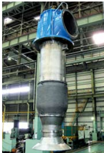
発電プラント向け 脱硫装置用海水ポンプ (鋼板製) 口径：1,500mm 原動機出力：1,500kW
