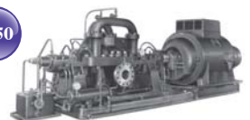
1951年(昭和26年) 発電所向けボイラ給水ポンプ (当時の火力発電所で使用される 最も圧力の高いボイラ給水ポンプ)
