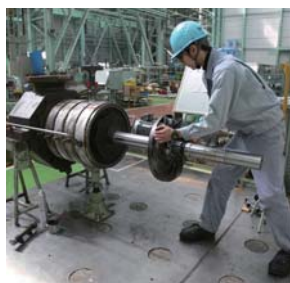
ポンプのオーバーホール
