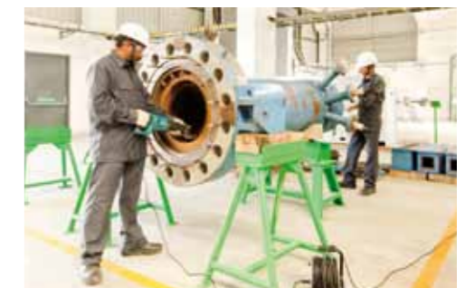
インドサービス工場でのポンプのメンテナンス
