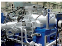
発電プラント用 ボイラ給水ポンプ
