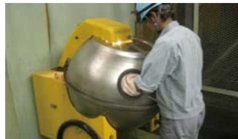
水垢除去作業中
